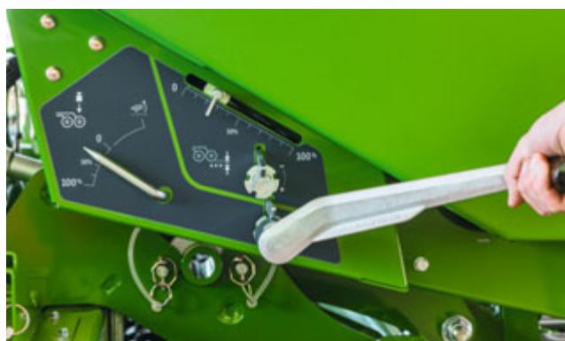
Централизованная бесступенчатая механическая регулировка давления на сошник со шкалой Cataya Super
