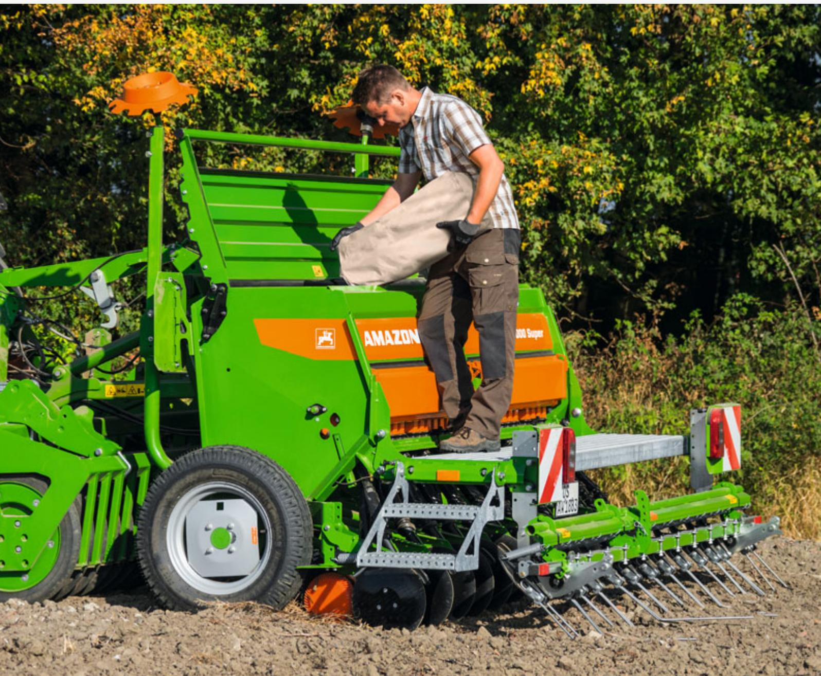
Безопасный подъём по складным ступенькам и платформе обеспечивает легкий доступ к семенному бункеру.
