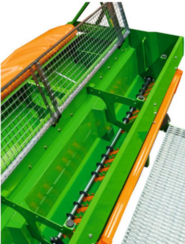
Бункер для удобрений системы C-Drill с возможностью дооснащения устанавливается снаружи на семенной бункер сеялки D9 Super
