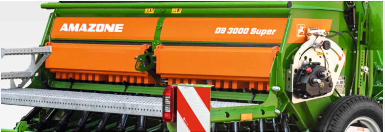
Семенной бункер D9 с редуктором Vario с бесступенчатой регулировкой
