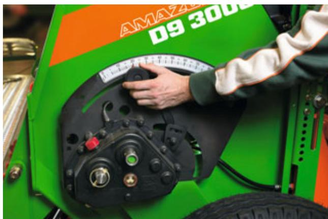
Настройка нормы высева непосредственно на машине
